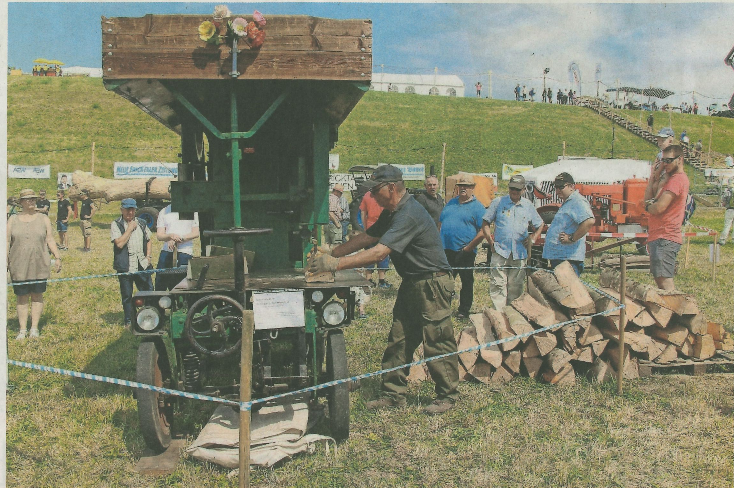
Die fahrbare Brennholz-Bandsäge mit Spaltapparat ist noch voll funktionstüchtig und fasziniert die Besucher.
