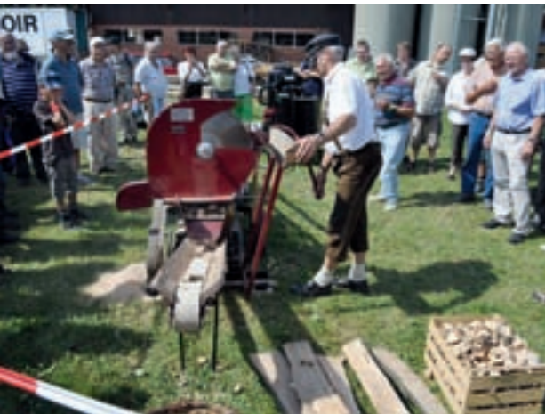
Günter Hartmann aus Dettighofen bei Waldshut stellte mit seiner Tankholzmaschine den «Treibstoff» (Buchenklötzchen) für seinen Fahr-Holzgastraktor von 1943 gleich selber her. Selbstverständlich wird die Maschine von einem Holzgasmotor angetrieben!
